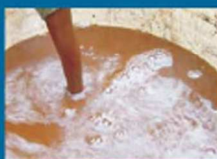
Eau de chauffage chargée en boue
